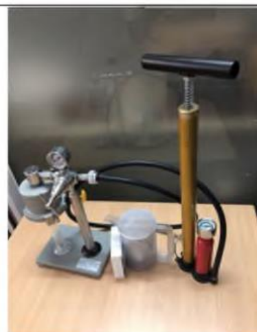
Thiết bị đo độ dày áo sét và lực cắt tĩnh Bentonite Xuất xứ: Trung Quốc
