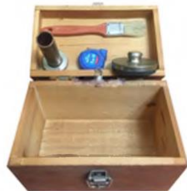
Bộ đo nhám mặt đường Road roughness Equipment Xuất xứ: Việt Nam
